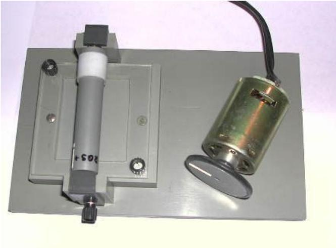
**Das einfache aber interessante Experiment von Cristian Monstein (1990): Ein axial polarisierter Stabmagnet (im Plastikrohr) wird mit einem Elektromotor zuerst in die eine, dann in die andere Drehrichtung bis zu einer konstanten Drehzahl beschleunigt. Danach wird die Zeit bis zum Auslauf gemessen. Diese sollte – bis auf kleinste Kugellagerasymmetrien – für beide Drehrichtungen identisch sein. Monstein wies aber signifikante Unterschiede in der Rechts- bez. Linksrehung nach [13].**
